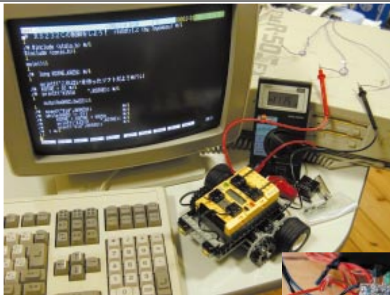
上：ちょっと昔のパソコンですが、制御ソフトを作って動作の確認をしているところ。手前のレゴのおもちゃは今回は説明できませんでしたが、これまた画期的なシロモノですので、またの機会に。 右：工作した装置の心臓部。パソコンの端子（RS232-C）につなぎます。
