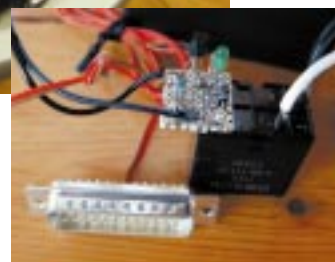
上：ちょっと昔のパソコンですが、制御ソフトを作って動作の確認をしているところ。手前のレゴのおもちゃは今回は説明できませんでしたが、これまた画期的なシロモノですので、またの機会に。 右：工作した装置の心臓部。パソコンの端子（RS232-C）につなぎます。
