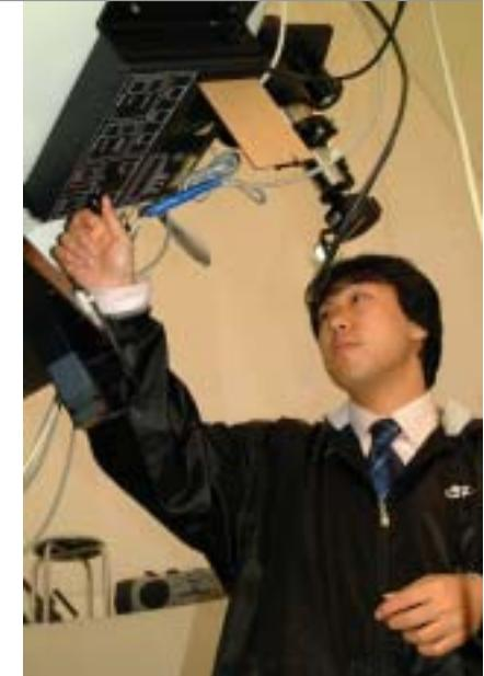
作業中の西端研究員。頭上すぐにある黒い円筒形が星の映像を捕らえるカメラ。操作しているボックスが、カメラのコントローラ。露出時間やオートガイダーの補正量の設定を行う。
