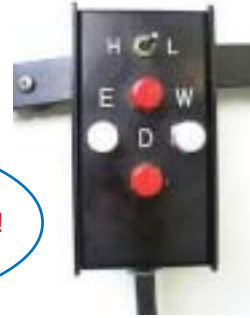
<点検・補修あれこれ> クランプ(ロック)が効かない、ハンドボックス内の断線など、望遠鏡の不具合をチェック! 写真: (右)クランプの基板 ハンドボックス
