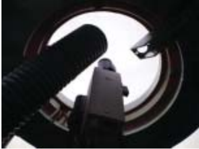
設置した「全天カメラ」 ダクト完備で完全くもり防止！
