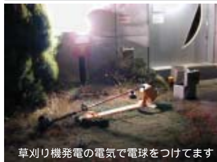
草刈り機発電の電気で電球をつけてます
