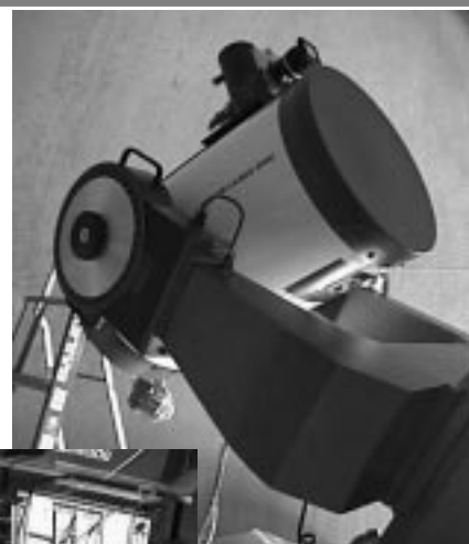
望遠鏡にレンズをつけたCCDカメラがのっているのがわかる。左はCCDのコントローラー。
