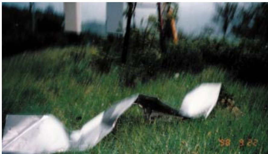
天文台敷地に散乱したドーム屋根のステンレス材（台風7号通過直後）
